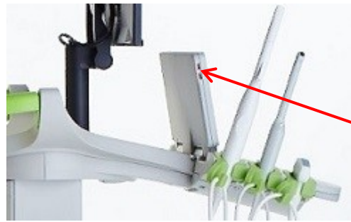
Figura 7: Connettori USB sul lato sinistro del touch screen
